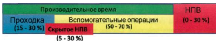
Рис. 1. Распределение времени на бурение и строительство скважины
